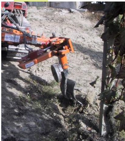
Versoio Dx - Sx Rincalzatore e scalzatore
