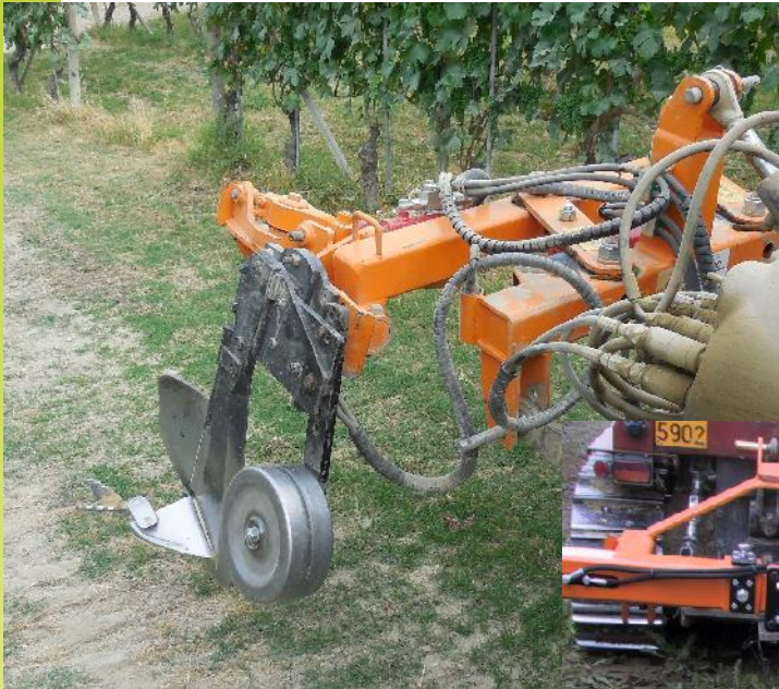
Versoio Dx - Sx Rincalzatore e scalzatore
