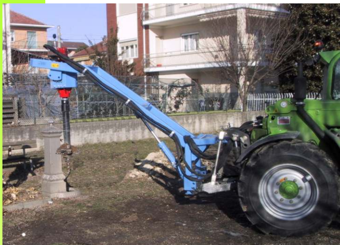
Trituraceppi su telaio per trattore agricolo Tree stump drilling connected to an agricultural tractor
