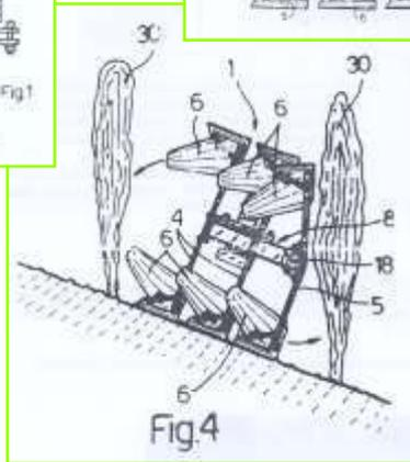
L'ultimo vomere si inclina automaticamente all'interno per evitare ostacoli bassi e sporgenti
