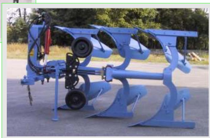
La sua particolare caratteristica, oltre ad essere compatto e maneggevole, è il terzo vomere inclinabile internamente. Questa particolarità consente di avvicinarsi il più possibile alle pareti curve delle serre. L'inclinazione, avviene contemporaneamente con il capovolgimento dell'aratro, riportando il corpo superiore in posizione normale di aratura
